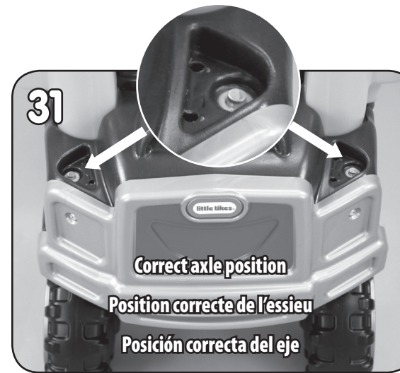
32 IMPORTANT! Check axle positions - roll truck forward. HUBCAPS SHOULD BE FACING OUTWARD. IMPORTANT ! Vérifiez les positions des essieux : faites rouler la camion vers l'avant. LES ENJOLIVEURS DOIVENT FAIRE FACE À L'EXTÉRIEUR. ¡IMPORTANTE! Verifique las posiciones de los ejes. Haga rodar el camión hacia adelante. LOS TAPACUBOS DEBEN MIRAR HACIA AFUERA.
