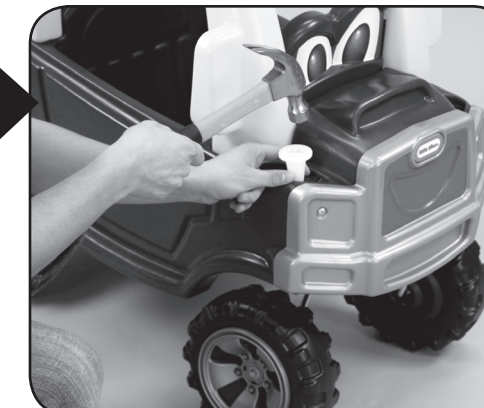
34 Place a top hat tool onto each top hat and hammer onto axle. Placez un outil pour écrou borgne sur chacun des capuchons de vis et martelez-les sur l'essieu. Coloque el dispositivo para tuerca tapón en cada remate y martillelo en el eje.
